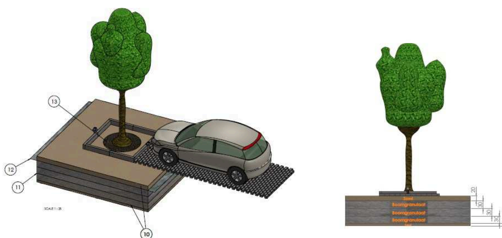
Figuur 9 Voorbeeld verbetering ondergrondse groeiomstandigheden met granulaat voor bomen in verharding.
